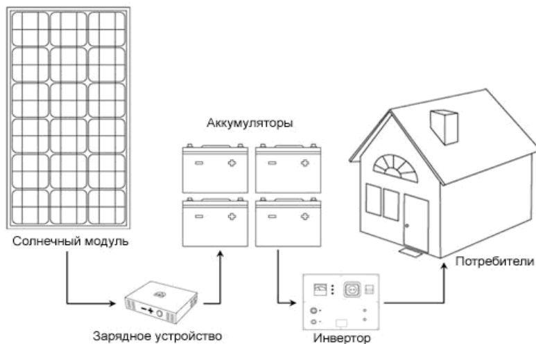
Рис. 3. Схема устройства солнечного источника энергии
